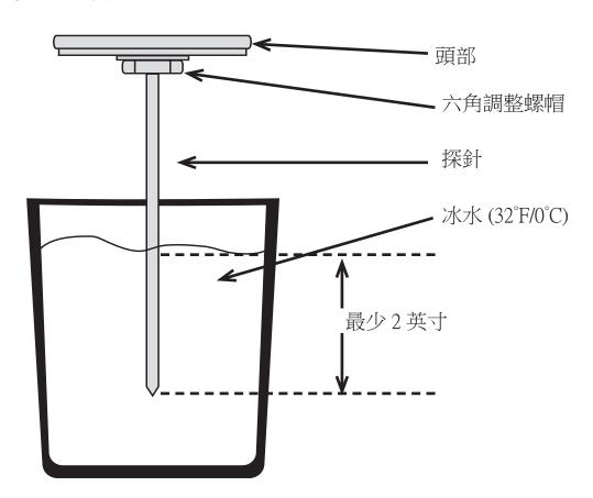
如果溫度計顯示 32°F 以上,準備一個深的碟子裝入沸騰的乾淨自來水。至少將探針 浸入水中 2 英寸,等待至少 30 秒,然後調整直到指針顯示 212°F。如上述步驟進行調整。
